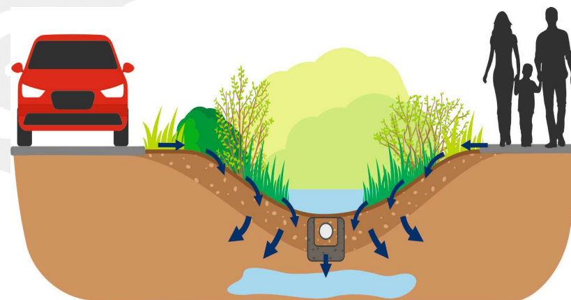
Schemat przepływu wody deszczowej przez rów wegetacyjny
